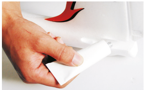
5. Kontaktfläche am Seitenleitwerk mit Klebstoff bestreichen. Beachten Sie Details zur Verklebung weiter hinten in der Anleitung.
