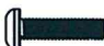
M3 x 12mm Button Screw (2) M3 x 12mm ボタンスクリュー (2)
