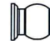
M5.8 x 7.5mm Ball Stud 3mm Hole (8) M5.8 x 7.5mm ボールスタッド 3mm ホール (8)
