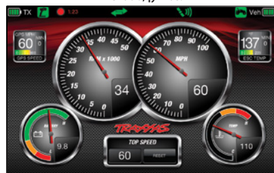
El tablero de instrumentos personalizado de Traxxas Link proporciona datos de rpm, velocidad, temperatura y voltaje en tiempo real.
