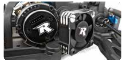
Updated fan mounts and fan location
