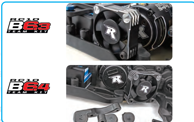
Updated fan mounts and fan location
