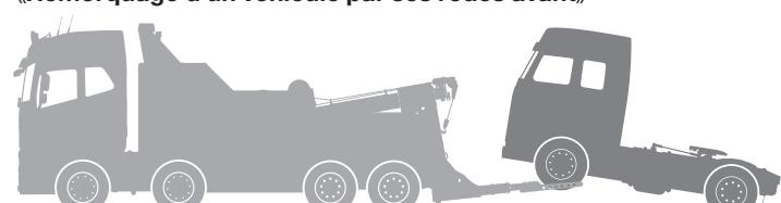
○ Mettre le véhicule remorqué en rapport supérieur, pour réduire la résistance à l'avancement.
