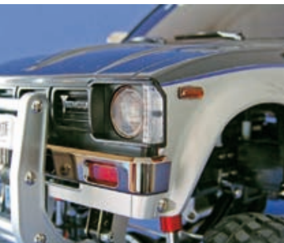
Die Lampengehäuse sind für den Einbau von LED vorbereitet
