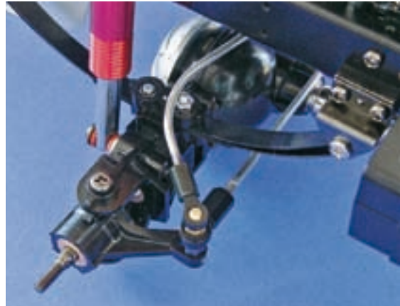
Ein kunstvoll geschwungenes Gestänge überträgt an der Vorderachse die Lenkkräfte...
