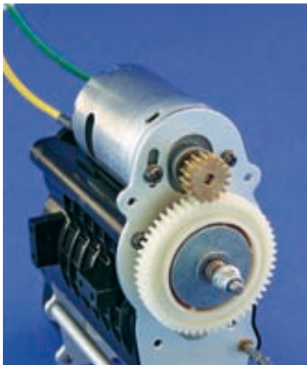
Das Motorritzel treibt das Hauptzahnrad mit integrierter Rutschkupplung an
