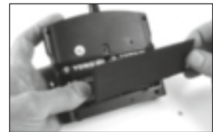
3. De afdekking van het batterijvak sluiten en dichtschoeven.
