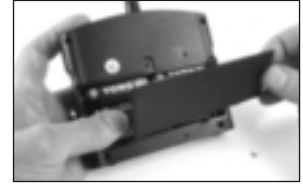
3. Pil bölümünün kapağını kapatınız ve vidalarını sıkıştırınız.
