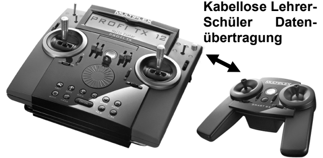
Lehrer-Schüler Betrieb in Verbindung mit einer PROFI TX von MULTIPLEX, mit Lehrer-Schüler Modul.
