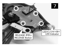
配線をはさまずに基板をビスで軽く止める。 トリムの作動を確認しながらビスをしっかり止める。 LEDインジケーターをはめる。 RELEASEボタンを載せる。
