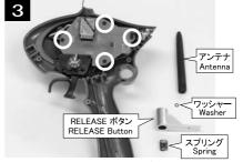
アンテナ、ワッシャー、RELEASEボタンを外す。 基板を止めている4本のビスを外す。
