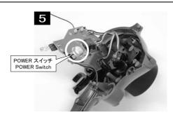
LEDインジケーターを外し、基板をゆっくりめくり 上げ、POWERスイッチを付替える。 スイッチの上下の向きに注意する。 To remove the Power Switch, first remove the LED Indicator and then slowly lift the circuit
