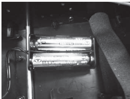
▶ バッテリーボックスに単3アルカリ乾電池をセットする。 Insert AA size alkaline batteries in the battery box.
