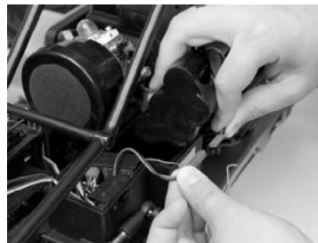
Insérez et connectez la batterie. Remettez le couvercle et serrez les 4 vis.
