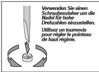
Verwenden Sie einen Schraubenzieher um die Nadel für hohe Drehzahlen einzustellen.
