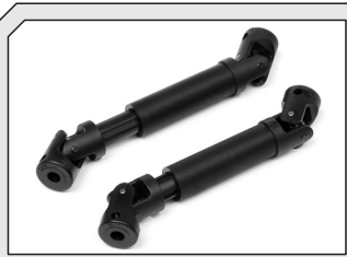
88119 UNIVERSAL CENTER DRIVE SET 66mm (FOR #86336) MITTELKARDAN SET 66mm (FUER #86336) ENS. ENTRAINEMENT UNI. CENTRAL 66mm (p. 86336) ユニバーサルセンタードライブシャフトセット66mm (#86336用)
