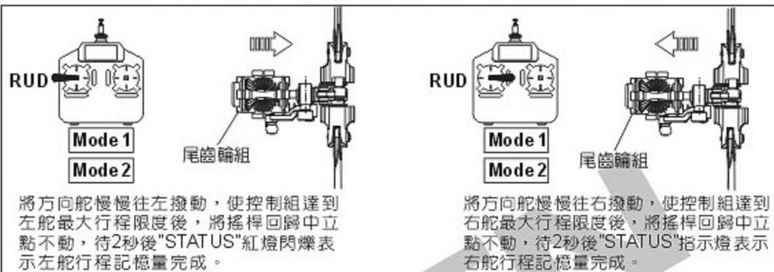
將方向舵慢慢往左撥動，使控制組達到左舵最大行程限度後，將搖桿回歸中立點不動，待2秒後"STATUS"紅燈閃爍表示左舵行程記憶量完成。
