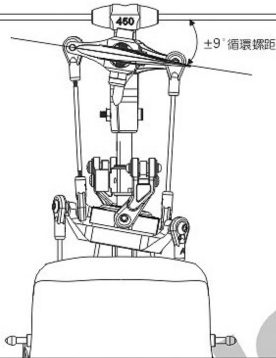
十字盤循環螺距最大角度設定：主旋翼方向與機體方向相同，油門搖桿置於主旋翼角度0度的位置不動，撥動副翼搖桿至最左，調整遙控器 Swash 中 AIL 比率，使主旋翼的攻角為原廠建議值9度。
