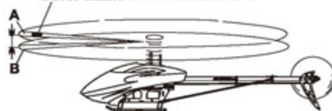
Color Mark 有標示記號的主旋翼
