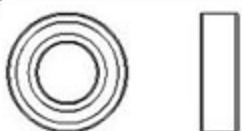
Bearing 轴承 (φ 10 x φ 19.5mm) x 2
