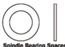
Spindle Bearing Spacer 橫軸止推墊圈(φ10xφ16x1mm) x 2
